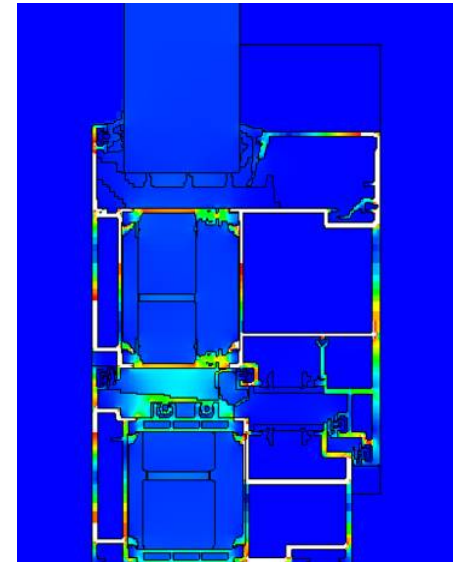
Schüco ADS 90 PL.SI U_f 1.4 W/m 2 K
